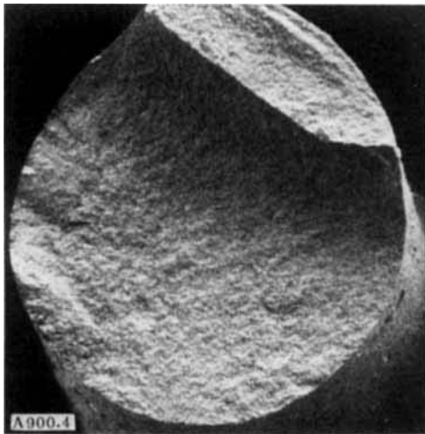
Abb. 4. Bruchflche eines nach dem Extrusionsverfahren hergestellten und flammengesinterten \text{Al}_2\text{O}_3 -Fadens [7].
